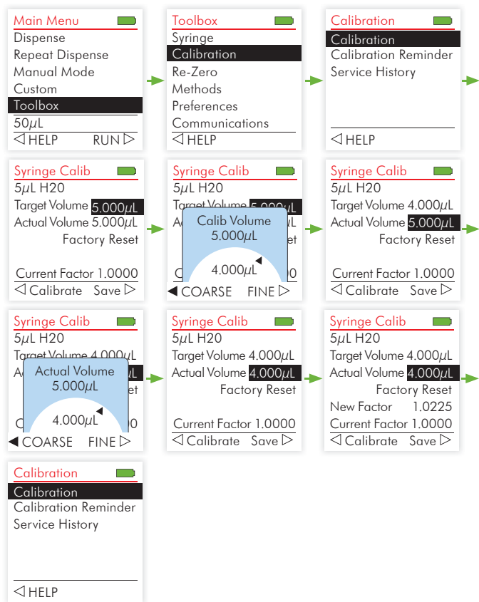
Figura 15. Como Ingresa la Información de Calibración al Instrumento
